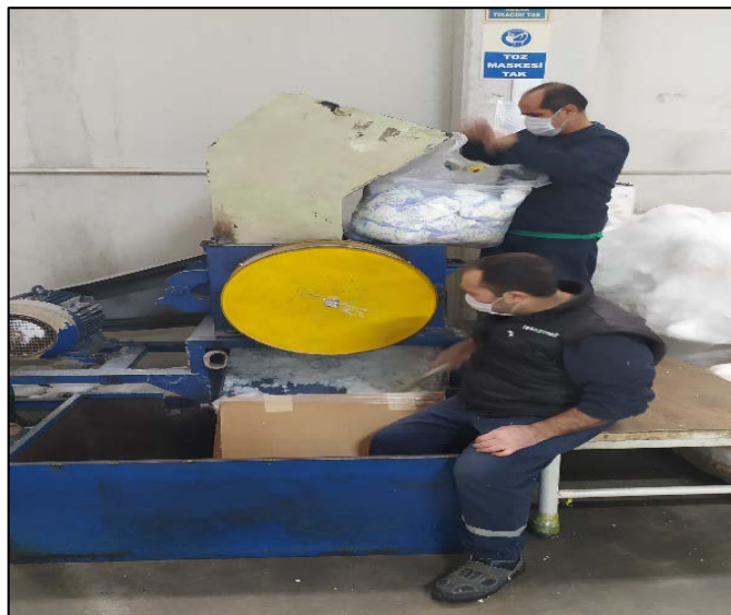
Şekil 3. Hurda Çocuk Bezi Teleflerin Kırma ve Ayırma İşlemleri
